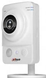
Cube camera IP da interno, con sensore CMOS progressivo 1/3", risoluzione 1.3Mp con 12 Fps, ottica 3.6mm, luminosita' 0.1 lux. White led portata fino a 10mt, porta LAN 10/100, sensore di allarme integrato portata 6 mt, privacy mask 4 aree, 2 D, D-WDR, microfono e altoparlante integrato, 1 slot micro SD Card, alimentazione 12Vdc o PoE IEEE802.3af massimo 4W, in dotazione staffa di fissaggio, software PSS e DMSS.
