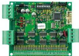
Scheda espansione 32 uscite logiche open collector ESP32-OCN per la segnalazione degli stati della centrale
