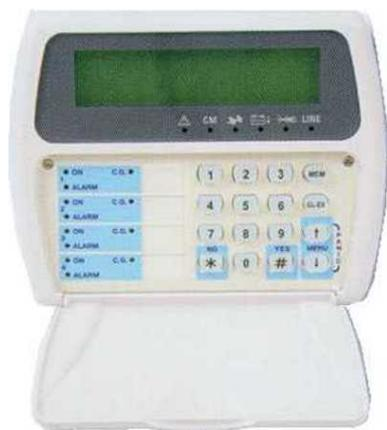
Tastiera di comando con display a LCD visualizzazione ON/OFF e allarme gruppi LCD 020 3.6" per centrale TP4-20
